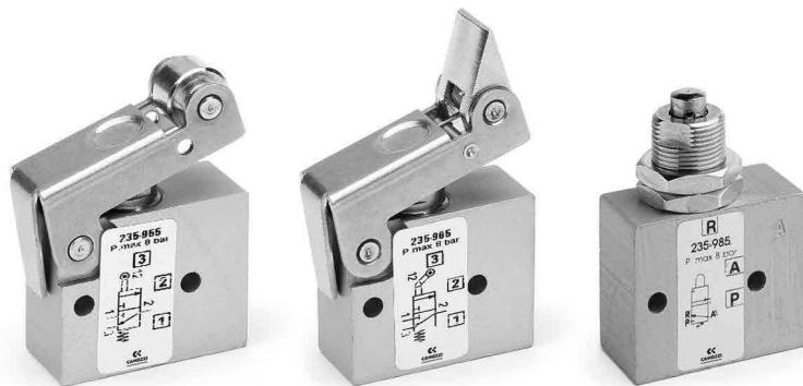
Las válvulas miniatura de mando mecánico de 3/2 vías, normalmente cerradas, Serie 2, se suministran con conexiones roscadas M5 o bien con racor super-rápido incorporado para tubos ø 4. Los dispositivos son de accionamiento frontal, de leva y rodillo y de leva y de rodillo unidireccional.
